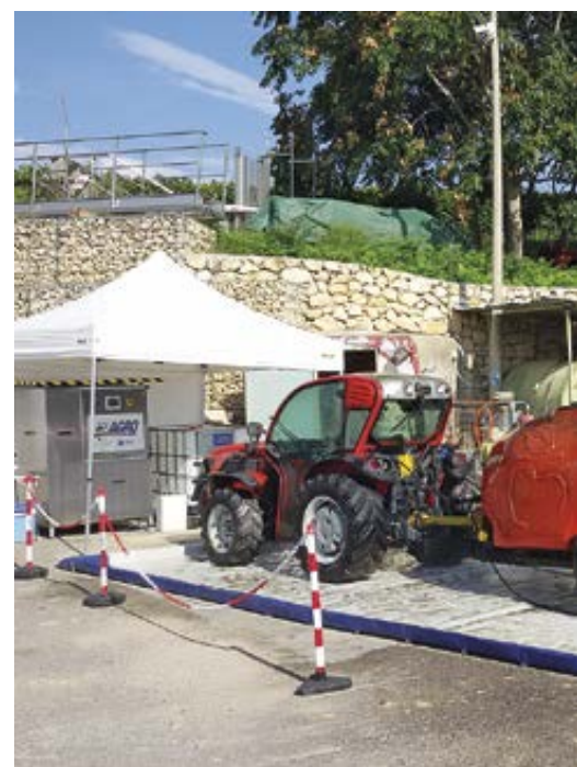
Esempio di piazzola di lavaggio mobile con impianto di depurazione dell’acqua nel Veronese.
