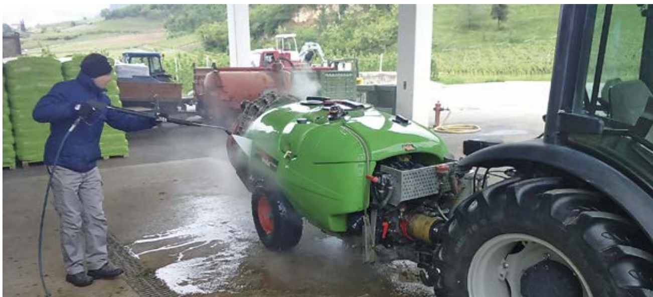
La pulizia esterna si dovrebbe effettuare solo in zone predisposte. Nella foto un atomizzatore usato in viticoltura.
